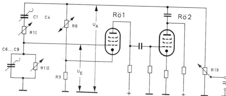
Bild 5. Vereinfachte Schaltung des RC-Generators im SRN
