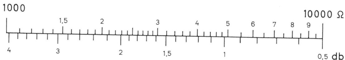
Bild 2. Nomogramm zur Ermittlung des db-Betrages, um den der am SRN einzustellende Leerlaufpegel höher sein muß als der gewünschte Ausgangspegel an einem gegebenen Außenwiderstand  $R_a = 10 \dots 10\,000 \Omega$
